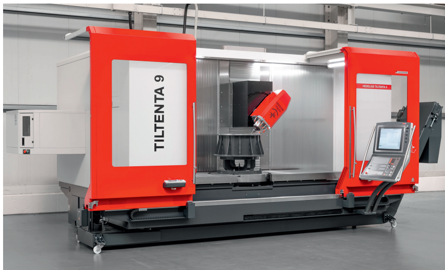
Für schwere kubische und lange Bauteile: 5-Achs-BAZ Tiltenta 9-2600 mit stufenlos schwenkbarer Hauptspindel © Hedelius
